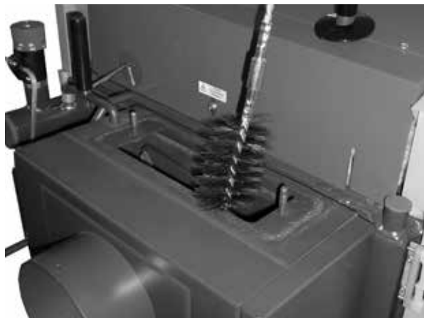
Пример очистки дымовых путь с проволоочной щеткой - верхняя крышка
