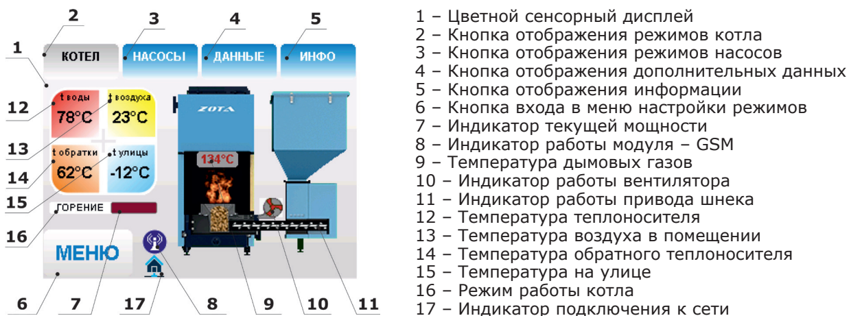
Рис.9 Расположение органов управления и индикации на передней панели пульта
